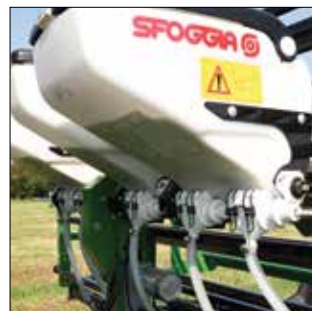
Microgranulatore PVC 18 L con 1 uscita/distributore volumetrico o 32 L con due uscite/distributori volumetrici a trasmissione elettrica o isobus
