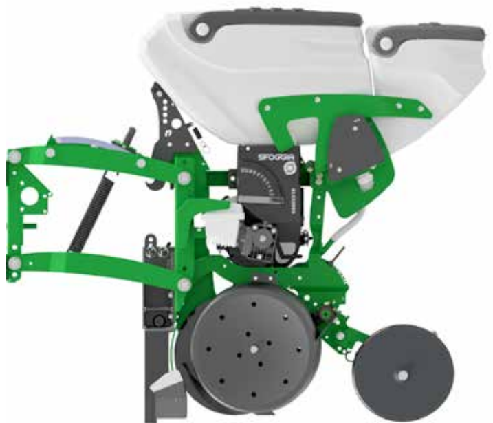
ELEMENTO DI SEMINA CON TRASMISSIONE A DOPPIA CATENA, TRAMOGGIA SEMI 60 L E TRAMOGGIA MICROGRANULATORE POSTERIORE 20 L
