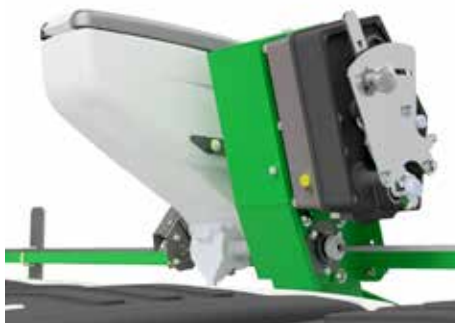
Trasmissione VERSIONE PLUS, con variatore a tre camme
