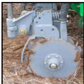
Assolcatore a doppio disco turbo per il concime
