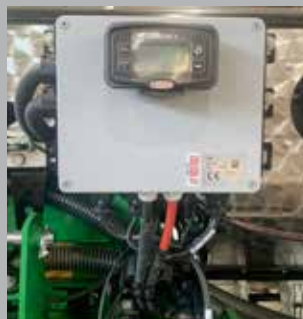
Centralina di comando nella versione ELEKTRA o ELEKTRA ISOBUS
