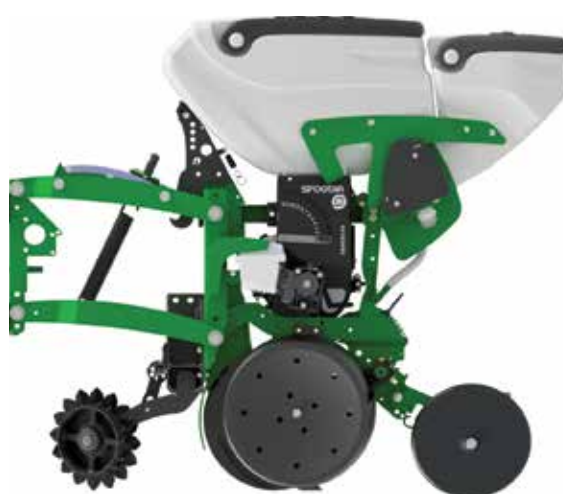
Spargiresiduo rotativo flottante
