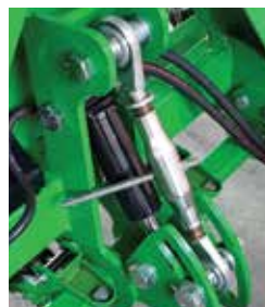
Sistema di sollevamento idraulico assollatori per macchina trainata
