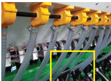
A richiesta il tubo di discesa seme in gomma entra nel tubo di caduta seme
