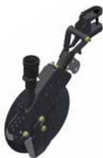
DRILL SEM DSDD-S con assolcatore a disco doppio
