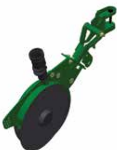
DRILL SEM DSDD-S con assolcatore a disco doppio
