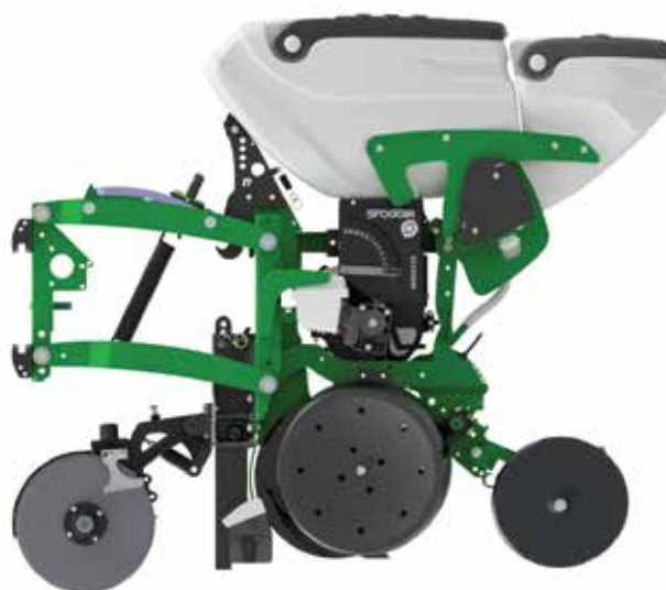
Assolcatore concime a disco doppio montato sull'elemento
