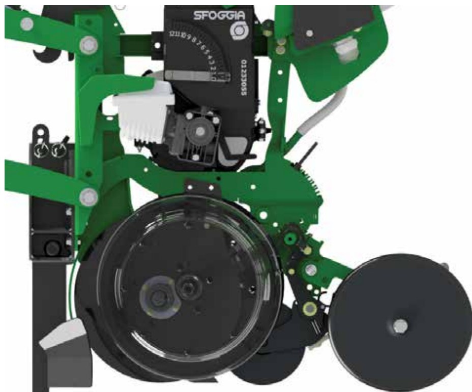
Ruotino premiseme in acciaio con possibilità di dissinnesto veloce
