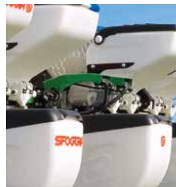
Trasmissione ELEKTRA, ELEKTRA ISOBUS su versione AIR
